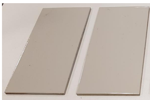
Imagen de las muestras tras el ensayo de niebla salina NSS
