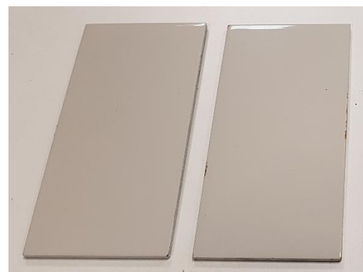
Imagen de las muestras tras el ensayo de niebla salina NSS
